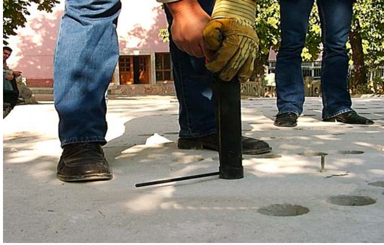
Şekil 1. Windsor probe penetrasyon testinin uygulanması
