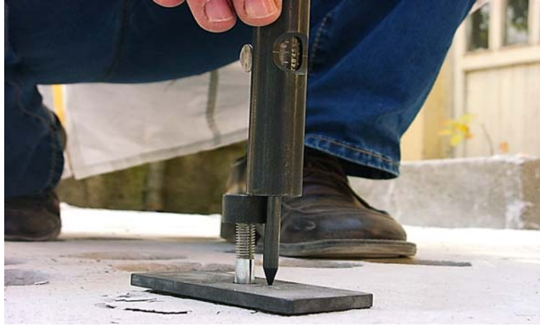
Şekil 2. Sondanın beton yüzeyi dışında kalan kısmının derinlik göstergeli aletle ölçülmesi
